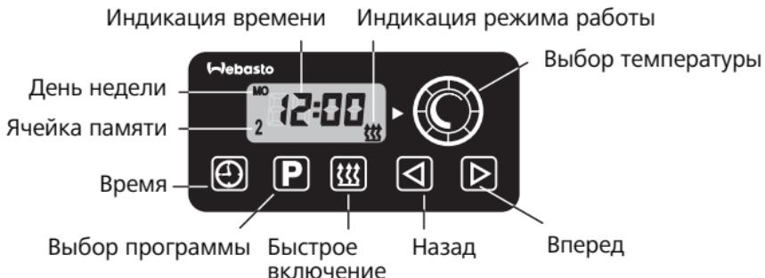
На таймере можно задать время начала отопления на период до 7 дней.
